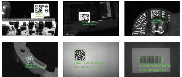
Hotbars II 기술과 결합된 1DMax는 손상되었거나 인쇄품질이 양호하지 않은 0.8PPM(Pixels per Module) 크기에 불과한 1-D 바코드를 고속으로 판독할 수 있다.
